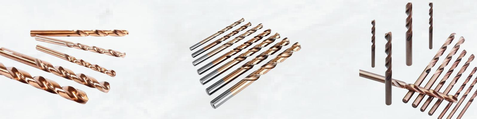
A broca DURATEC - Linha TITAN é feita em aço rápido (HSS) sob a norma internaciona DIN-338, tem acabamento brilhante e revestido de Titânio, é o tipo de broca mais versátil, afiada e alto rendimento. Podendo ser usada em qualquer usinagem de materiais com dureza inferior a 63 HRC.
